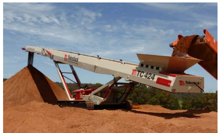
TC 424 AUFHALDUNG NACH EINER MOBILES SIEBANLAGE
