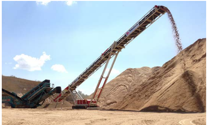
TC 431 AUFHALDUNG HINTER EINER MOBILEN SIEBANLAGE
