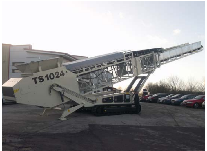
TS 1024 TELESKOPIERBARES FÖRDERBAND AUF RAUPEN (1000 TO/H)
