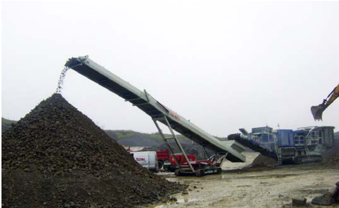
TC 621 AUFHALDUNG HINTER EINEM BACKENBRECHER ( 0-200 MM / 600 TO/H )
