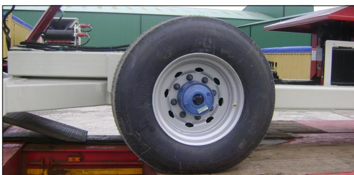
Automatischer hydraulischer Radantrieb (zur Schwenkung des Förderbandes)
