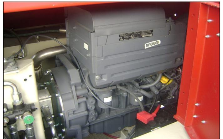
Diesel-hydraulischer Antrieb (Option: Dual Power)
