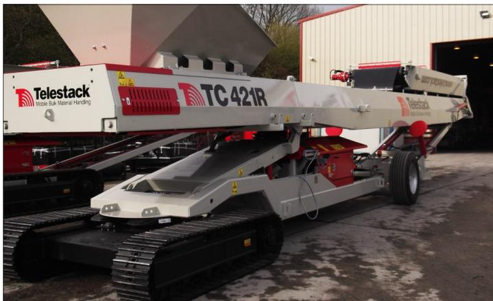
Breite Kettenlaufwerk 1,80 m
